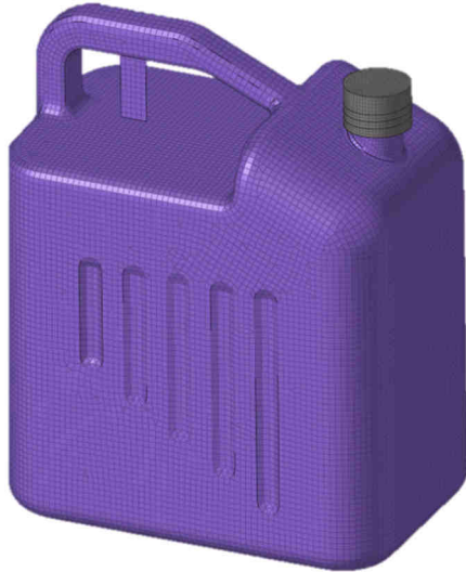
Figura 24 – Mallado con elementos 2D – Envase JOPI 10 L
