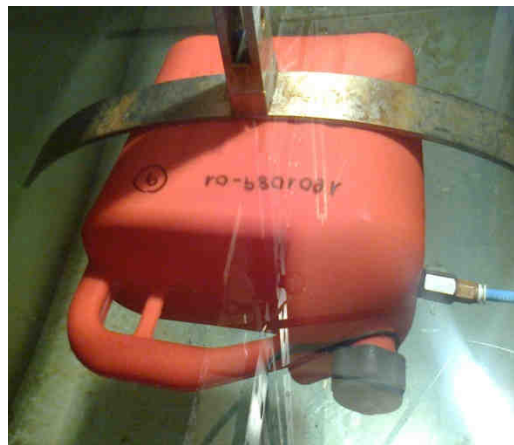
Figura 7. – Ensayo de estanqueidad a 20 kPa
