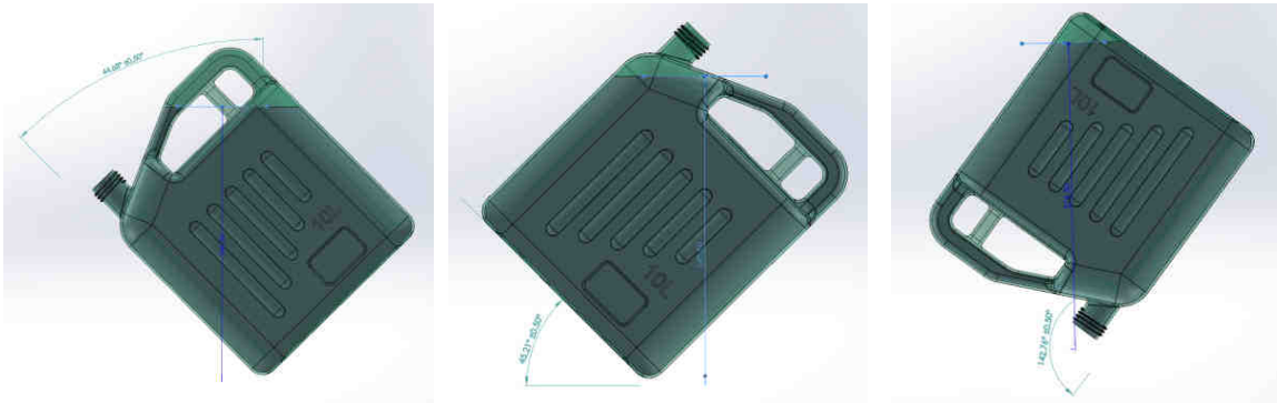
Figuras 31, 32 y 33 – Posiciones para el ensayo de caída libre para Garrafa JOPI 10 litros
