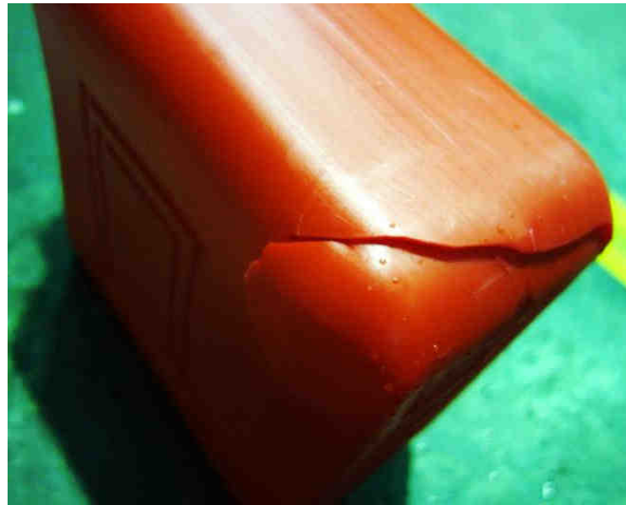
Figura 3.- Rotura reborde trasero en el ensayo de caída de 1,2 m tras compatibilidad química con WS.
