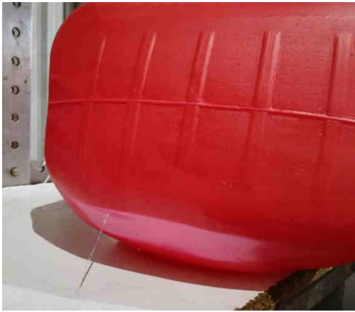
Figura 8. – Fallo en el ensayo de presión interna a la presión de 190 kPa
