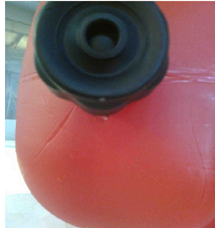
Figura 11. – Fallo en el ensayo de presión interna en el cierre
