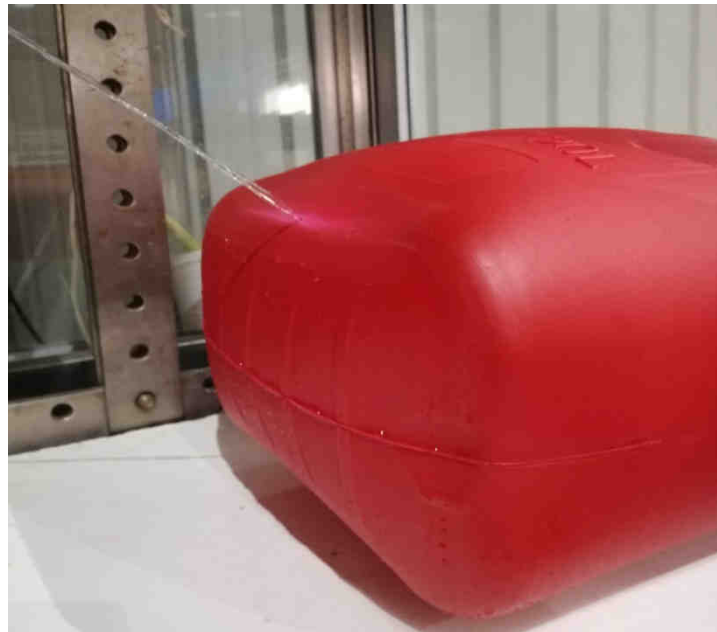
Figuras 50 –Ensayo real donde se produce fallo en presión interna. La zona de rotura corresponde a de la zona de mayor tensión calculada (rojo oscuro).
