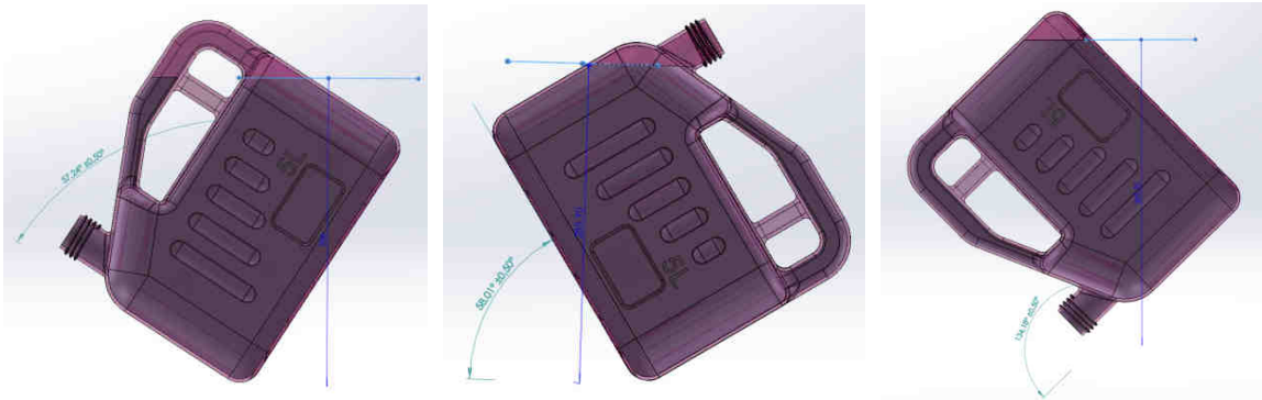
Figuras 35, 36 y 37 – Posiciones para el ensayo de caída libre para Garrafa JOPI 5 litros
