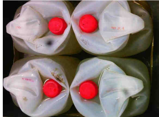
Figura 6.- Fallo durante el apilamiento con ST
