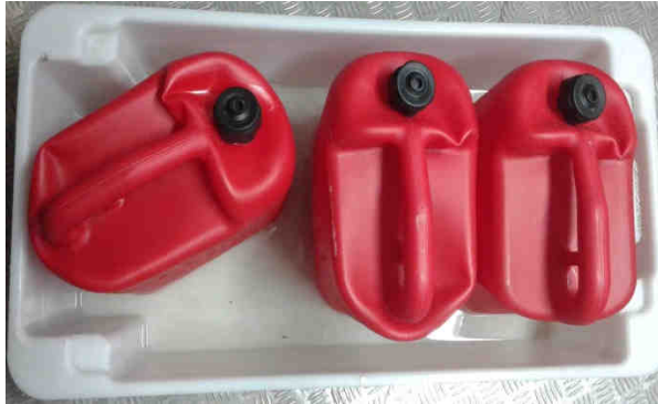
Figura 5. – Deformación observada tras apilamiento. Compatibilidad química previa con WS
